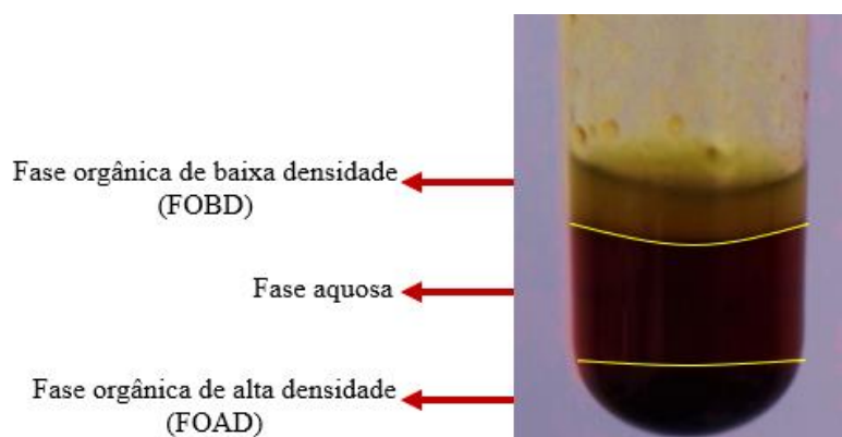
Fig. 2. Bio-óleo obtido nos testes de co-pirólise do CP/PE.
